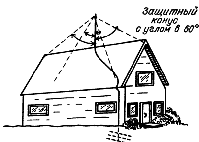
Штырь соединяется с влажной землей толстой проволокой без резких изгибов
